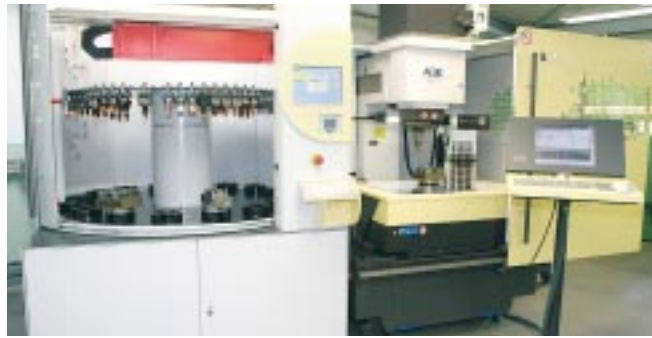
Hohe Flexibilität bei gleichzeitig gesteigerter Qualität: Senkerodiermaschine Impact 2 mit Magazin und Beladesystem für Werkstückpaletten und Elektroden.
